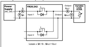
12-28V, 20A, DUAL REDUNDANCY MODULE
